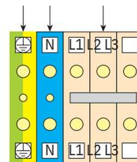
Vissez la barrette métallique (shunt) sur les bornes de phase L1-L2-L3 et raccordez la phase sur L2.
