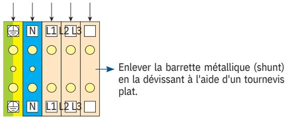
La chaudière électrique GRE6T40010A est prévue pour un raccordement triphasé.
