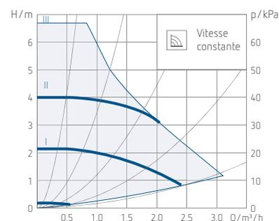
Réglage préférentiel pour un circuit dont les pertes de charge ne varient pas. La vitesse du circulateur est constante.
